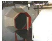
Düse und Messstrecke
